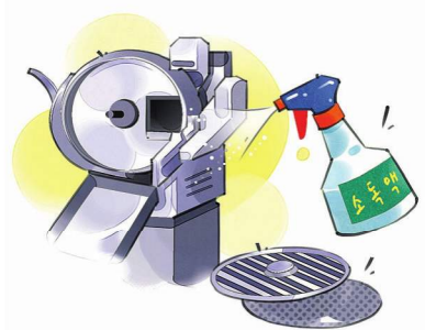
● 본체는 소독제(알코올 등 분사)로 소독 후 건조 ● 칼날 등 부속품 소독 후 건조 ● 칼날 등은 자외선 소독 보관을 권장하며, 소독제로 분무 건조 후 사용
