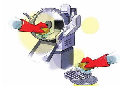
● 세척제를 사용하여 수세미로 세척 ※ 본체 전기 부분에 물이 들어가지 않도록 주의 ※ 칼날 세척 시 철수세미 사용 금지
